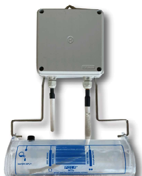
WT1s :Vaschetta Bulbo secco+umido
